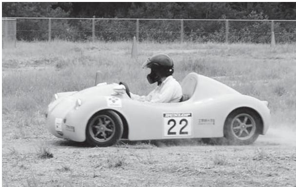
そこで、心機一転して各部門での優勝を目指して、出力を増強することにしました。まず5年前のリチウム電池の出力が低下していたので、新規に高性能のものを購入し、交換することにしました。これに伴って車体を補強し、各車輪に永久磁石界磁直流モータを2台並列に取り付けることで、出力アップを図りました。この結果、平坦路において60km/h以上で走行することが可能となり、加速性能も満足できる状態になりました。
