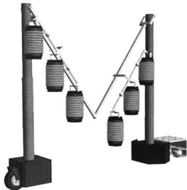
■ちょうちん——大型の自動マシンです。「ドンドン太鼓」と同様に、外側の木枠を伝い、ゴールのネットに取り付き、一度に6ゴールを決めます
