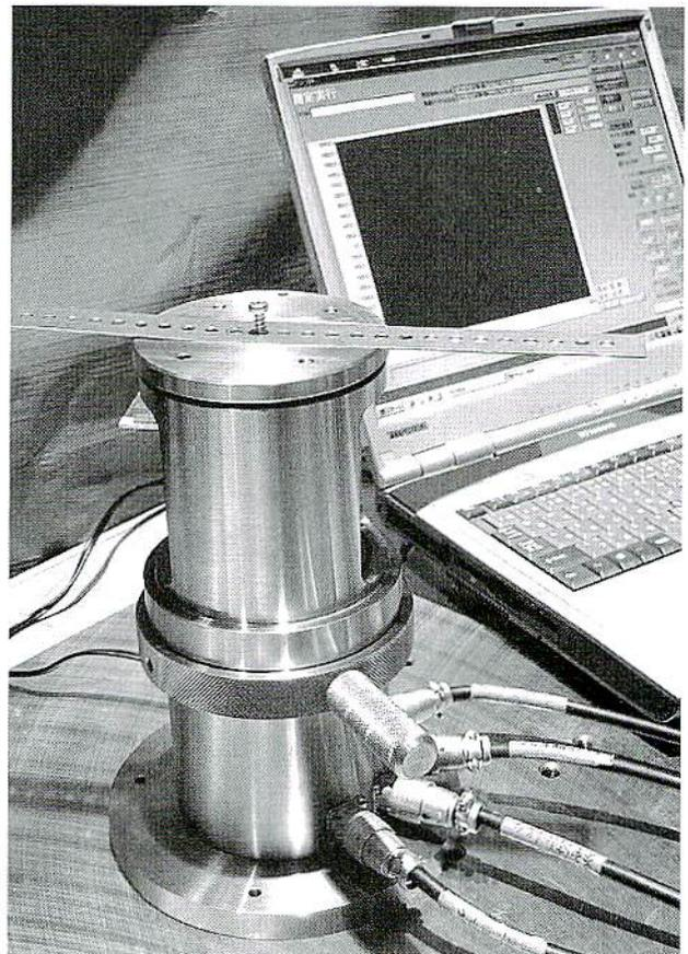
小ねじ締付け試験機用ロードセル
